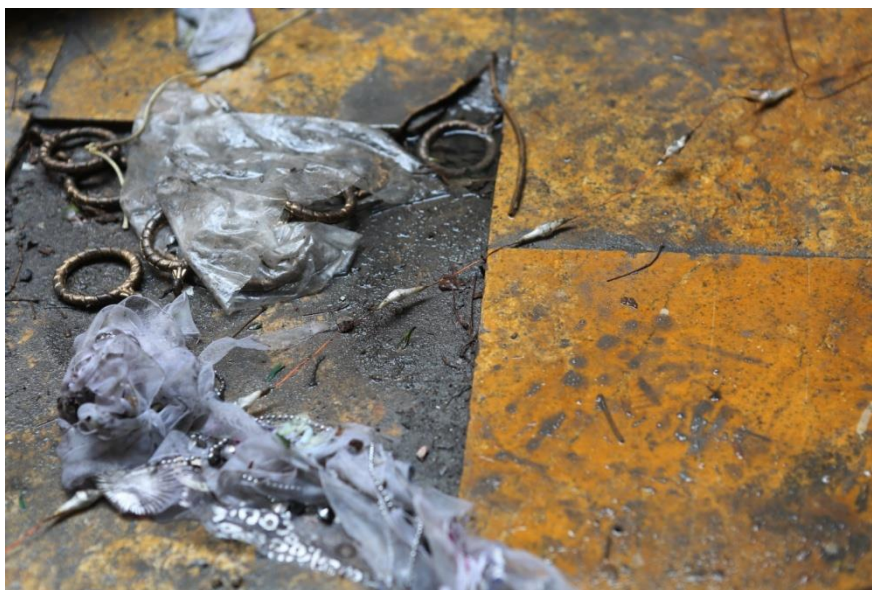
«Гирлянда» – контактная нить нажимного действия (выкладывается на пол под строительный мусор или ковровое покрытие).
